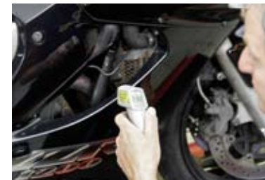
Geoordeeld naar de temperatuur van de vier uitlaten is de synchronisatie goed.
