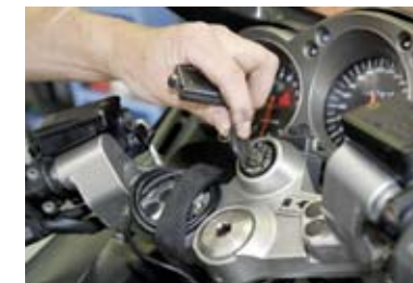
Het contactslot zit behoorlijk los in de behuizing.
