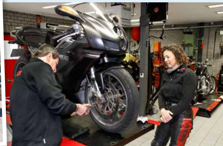
De remschijven zijn na 155.000 kilometer nog de originele. De remblokken hielden het zelfs ruim 150.000 kilometer vol.
