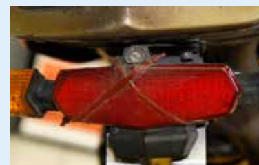
Een trekbandje is nodig om te voorkomen dat om de haverklap het achterlicht los trilt.
