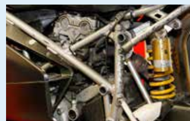
'Sproeten' vanwege het kettingsmeren.
