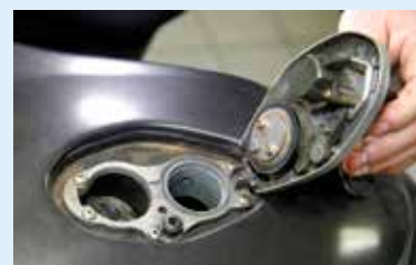
Omdat het voorspatbord aan de kortekant is, gooit het voorwiel veel troep omhoog, tot in de vuldop toe.
