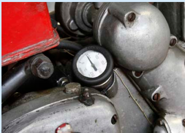
Een meter uit een frituurpan registreert de olietemperatuur.
