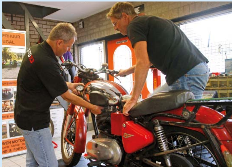
De Enfield uit 1982 heeft niet de luxe van een elektrische starter. De compressie bedraagt nog altijd een keurige acht bar.
