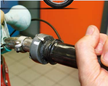
Wanneer het pijltje boven het streepje staat, levert de Enfield zijn volle vermogen: 18 pk.
