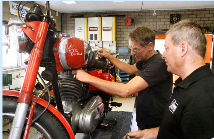
Benno Graas weet zelf het best hoe hij zonder problemen de bougie kan monteren. De schroefdraad in de cilinder is niet helemaal lekker.
