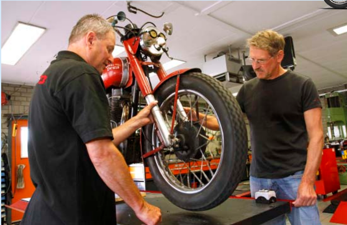
Na de nodige valpartijen en een aanrijding is de voorvork niet meer helemaal recht.
